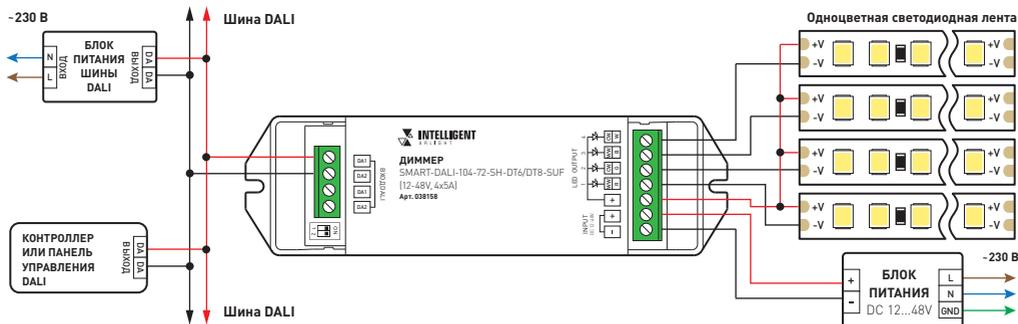
Рис. 1. Пример схемы подключения диммера в режиме DIM
