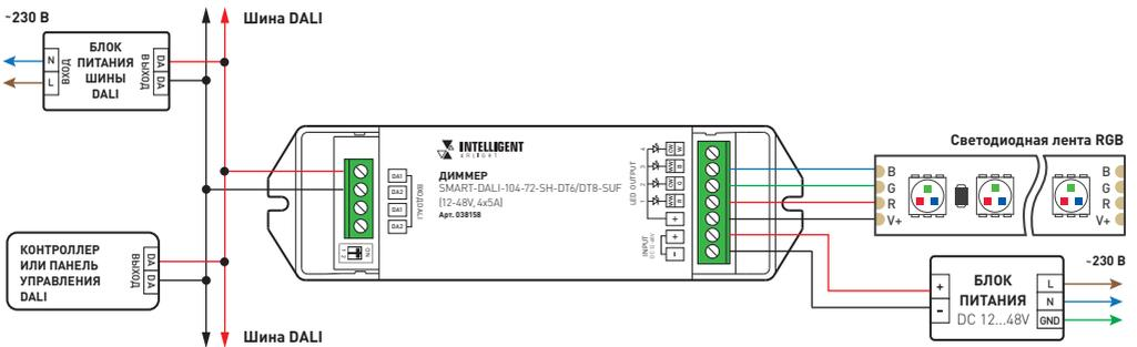
Рис. 3. Пример схемы подключения диммера в режиме RGB
