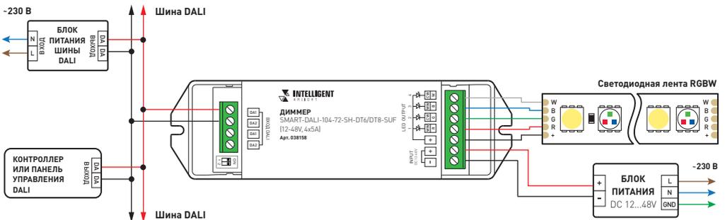
Рис. 4. Пример схемы подключения диммера в режиме RGBW
