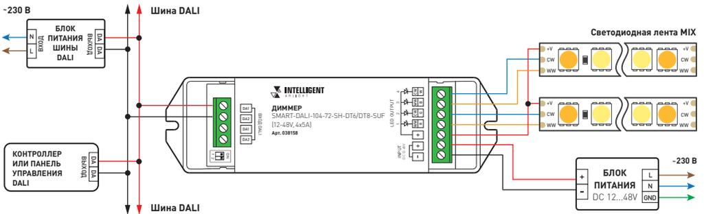
Рис. 2. Пример схемы подключения диммера в режиме MIX
