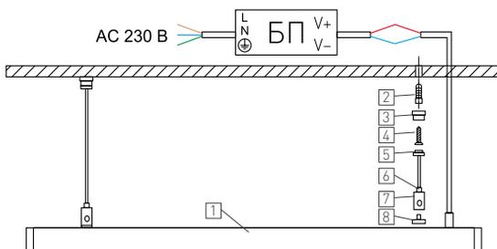
Рис. 2. Монтаж светильника
