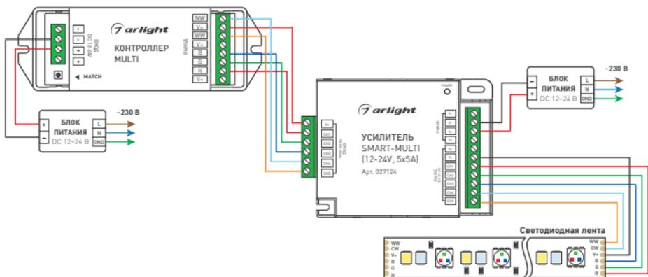
Рис. 1. Схема подключения усилителя SMART-MULTI
