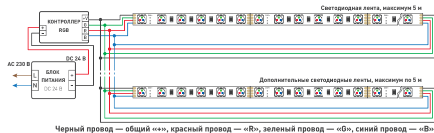
Схема 2. Подключение нескольких светодиодных лент с двух сторон
