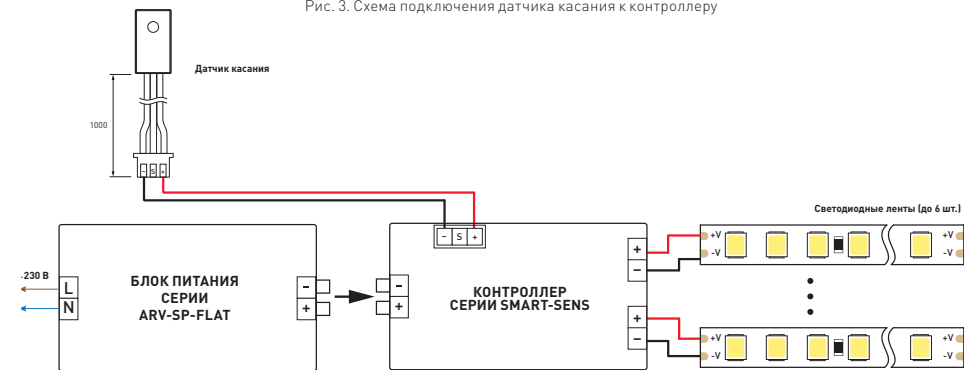
Рис. 3. Схема подключения датчика касания к контроллеру
