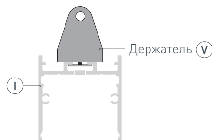
Рис. 1. Установка держателя в паз профиля. Вид сбоку
