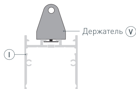
Рис. 1. Установка держателя в паз профиля. Вид сбоку
