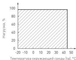
Рис. 3. Максимальная допустимая нагрузка, % от мощности источника
