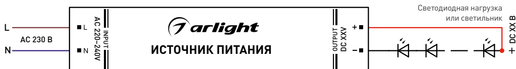
Рис. 1. Пример подключения источника питания
