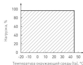
Рис. 3. Максимальная допустимая нагрузка, % от мощности источника
