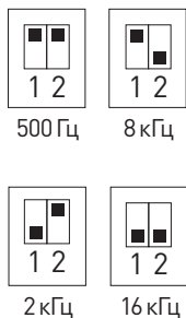
Рис. 3. Установка частоты ШИМ
