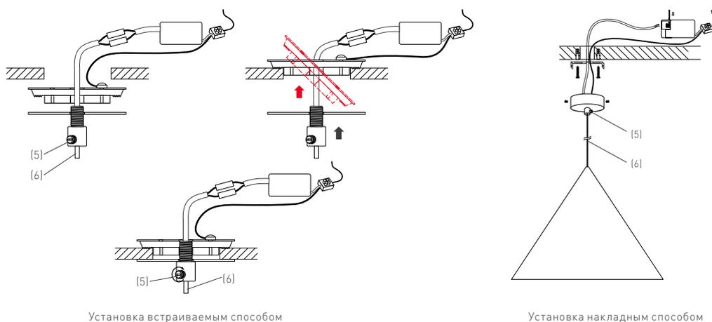
Рис. 3. Установка и подключение светильника
