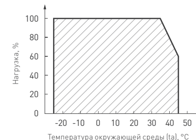
Рис. 3. Максимальная допустимая нагрузка, % от мощности источника
