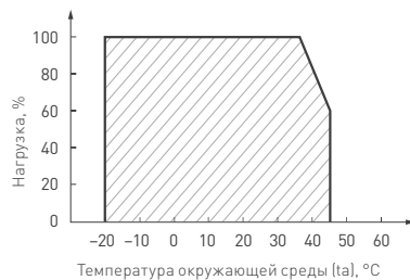
Рис. 2. Максимальная допустимая нагрузка, % от мощности источника
