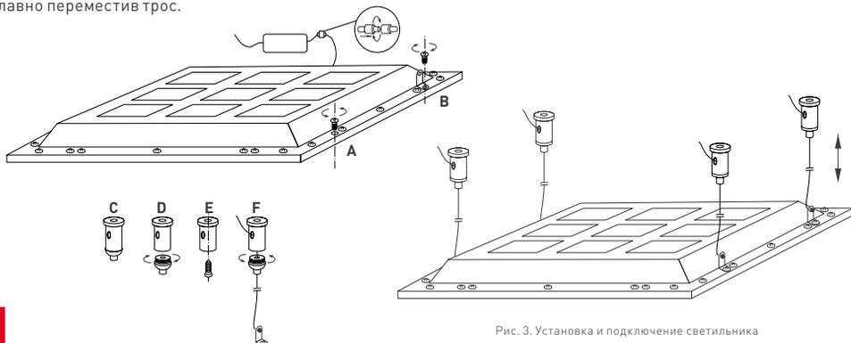
Рис. 3. Установка и подключение светильника
