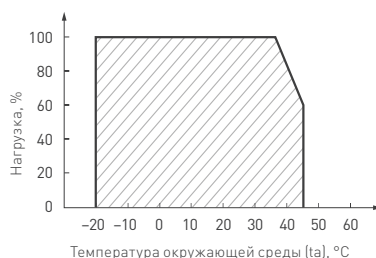
Рис. 2. Максимальная допустимая нагрузка, % от мощности источника
