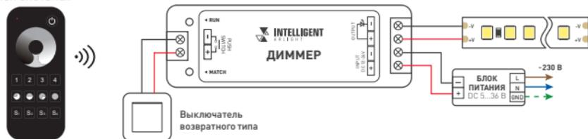
Рис. 1. Схема подключения диммера
