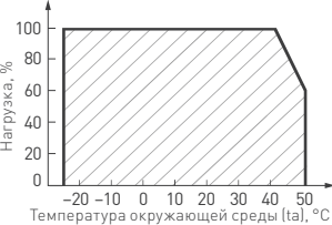
Рис. 5. Максимальная допустимая нагрузка, % от мощности источника
