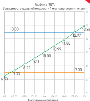
График 1. Зависимость удельной мощности от напряжения питания
