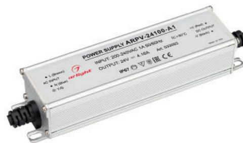
Блок питания для светодиодной ленты Arlight ARPV-24100-A1 обеспечивает напряжение на выходе 24 В, номинальный ток нагрузки составляет 1,6 А. Возможность работы при температуре до +90С° позволяет размещать блок питания в произвольных местах, где он будет незаметен. Степень защиты IP67 для оборудования, применяемого на массовых мероприятиях, даже в помещении, не лишняя — даже если в здании протечет крыша или прорвет водопроводную трубу, электрическая безопасность будет обеспечена
