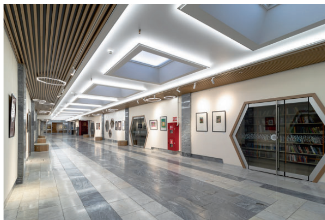
В галерее установлены светильники шестиугольной формы на основе тонкого алюминиевого профиля, изготовленные на заказ
